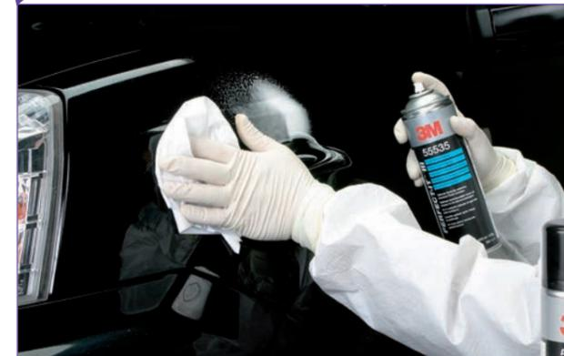
Contrôle de la surface avec le révélateur de finition. S'il reste des rayures, l'opération de polissage est à refaire.
